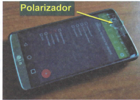
Figura 1. Polarizador colocado sobre el sensor de luz ambiente, típicamente ubicado junto a la cámara frontal.
